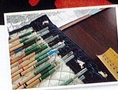
丸キリ 小さな丸は、その大きさにあった丸キリ(丸鋸)と呼ぶ道具を使います。
